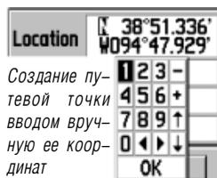
Создание путевой точки вводом ручную ее координат
